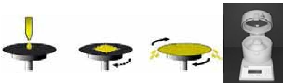
**Figura 119.** Técnica de spin coating donde se muestra la aplicación, esparcimiento y centrifugado de la muestra y un equipo la elaboración de películas por spin coating.
