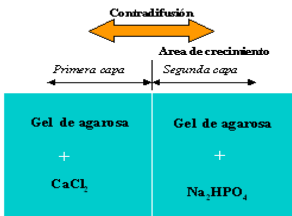
Figura 5. Esquema que representa el cassette de vidrio construido para la formación de los cristales de HAP en geles de agarosa.
