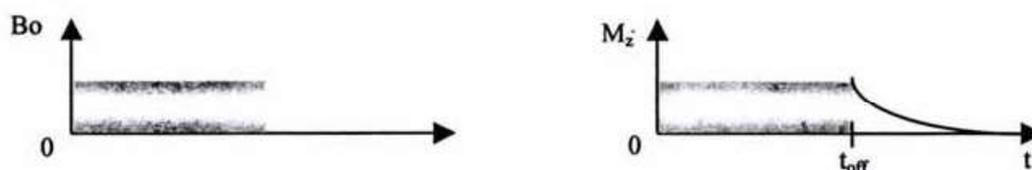
Figura 1.5 Relajación longitudinal  $T_1$  después que el campo  $B_0$  es apagado
